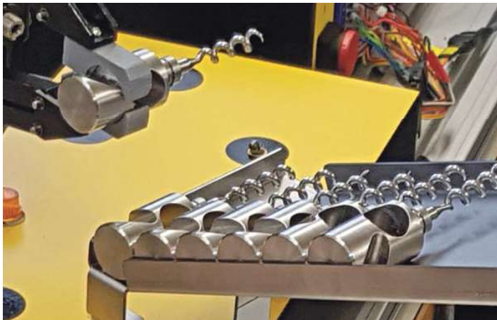
Das Handlinggerät übergibt den kompletten Flaschenöffner zur Verpackungsstation.
